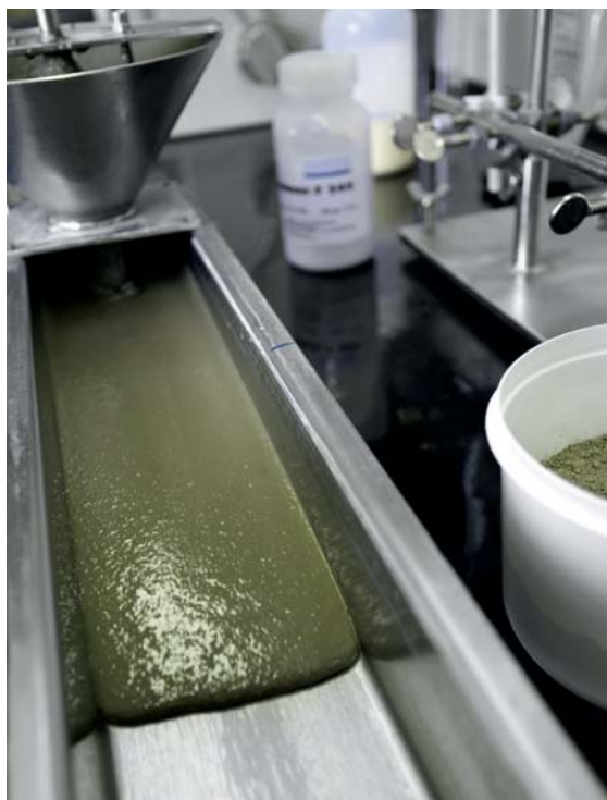
Bauchemie: Zusatzmittel erhöhen die Fließfähigkeit von Mörtel. Der hier gezeigte Fließbrinntest gibt Aufschluss über die Konsistenz des Baustoffs. (Foto: BASF).
