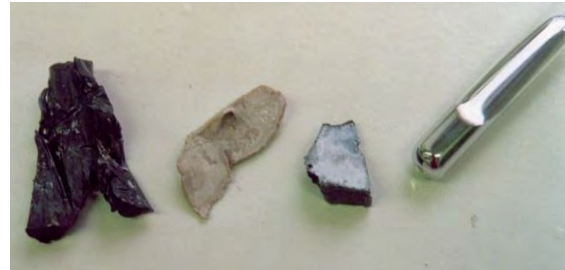
Abb. 2.1: Alkalimetalle (von links nach rechts: Lithium Li, Natrium Na, Kalium K und Rubidium Rb; im Periodensystem von oben nach unten stehend, zunehmend leicht schmelzbar und reaktiv)
