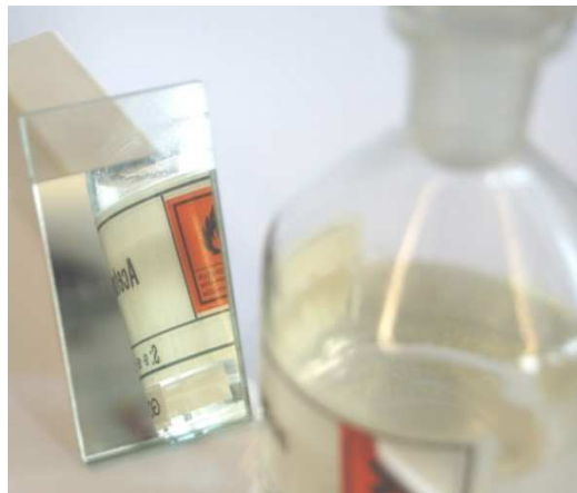
Abb. 17: Blick auf die leitfähige Seite des FTO-Glases: Abgeschiedener Silberspiegel befindet sich auf der nicht leitfähigen Rückseite des FTO-Glases.
