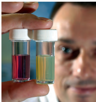
Thomas Schneider von der Uni Jena synthetisiert und charakterisiert Nanopartikel. Hier zeigt er Lösungen mit Nanokügelchen aus Gold (links) und Silber. (Foto: J.-P. Kasper/FSU)
