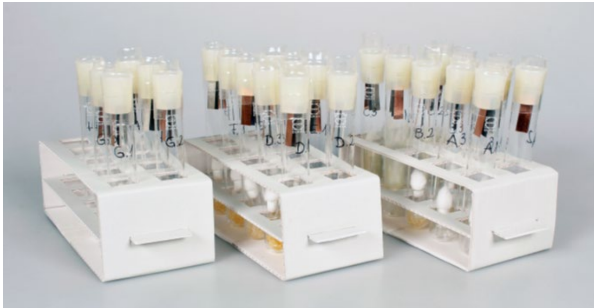
Abbildung 1: Der Oddy-Test ist wegen des geringen Aufwands an Gerät, Material und Platz ideal für das Massen-Screening geeignet.
